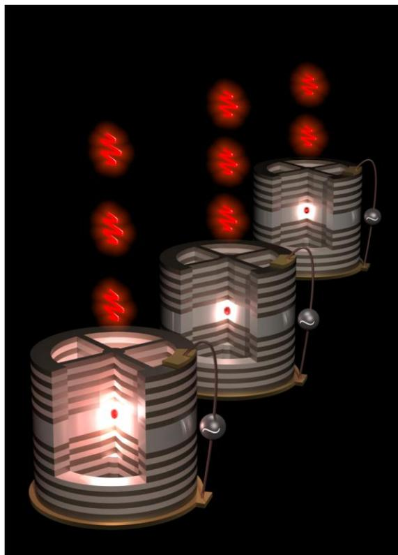
*Cette image représente plusieurs sources de photons uniques : représentée par un point rouge au centre de la cavité, la boîte quantique semi-conductrice (de taille nanométrique) est insérée au centre de la cavité qui consiste en un pilier de  $3\ \mu\text{m}$  connecté à un cadre circulaire par des guides de  $1.3\ \mu\text{m}$  de large. Grâce à la tension électrique appliquée sur la cavité, la longueur d'onde des photons émis peut être accordée et le bruit de charge totalement supprimé.*
